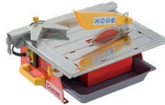
Cortadora eléctrica portátil adecuada para cortar en ángulo de 90°, 45° y también permite biselar a 45° los siguientes materiales: revestimiento de cerámica, porcelánico, mármol, granito y piedras naturales, con superficie lisa, rugosa o en relieve
